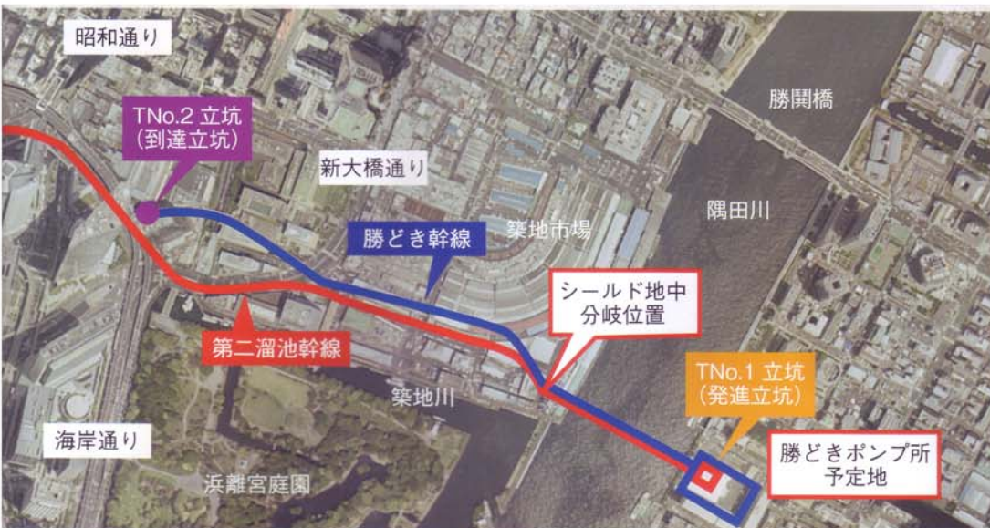
勝どき(右)～新橋(左)間に巨大な下水管を通す68億円の工事 = 都下水道局資料
